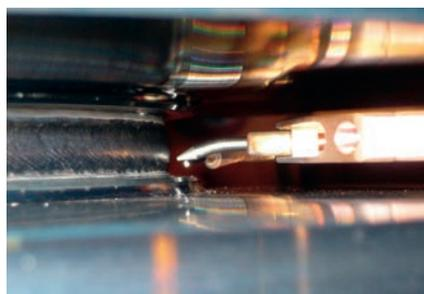
Fig. 24: Saldatura a passate tirate multiple per strato con elettrodo curvo
