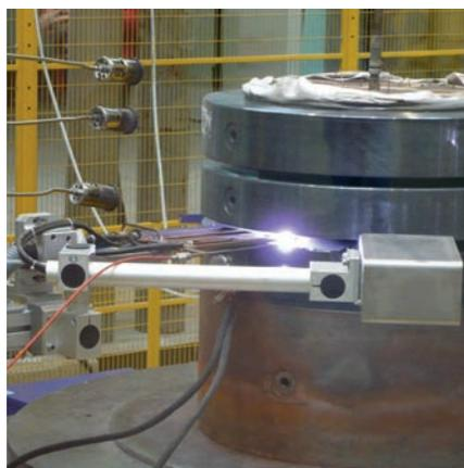
Fig. 13: Torce NG-7 (spessore 7mm) con lancia di saldatura isolata
