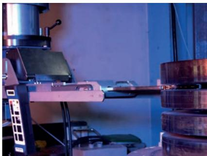
Fig. 37: Testa di saldatura per applicazione su rotore turbina
