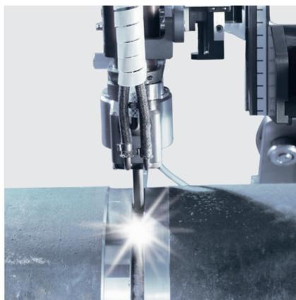
Fig. 7: Torcia NG-V2 o V3 torch per spessori da 0 a 100mm
