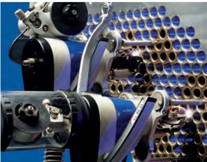
Testa di saldatura tubo-piastra Polysoude TS 8/75
