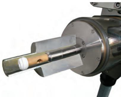
Esempio di saldatura di tubi arretrati a una piastra tubiera
