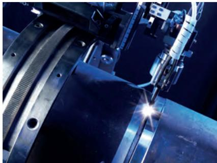
Testa di saldatura carrellata Polysoude Polycar
