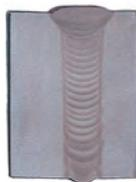
Sezione macrografica di una saldatura TIG con la tecnica narrow gap
