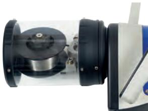
Alimentatore filo integrato su una testa di saldatura Polysoude TS 8/75
