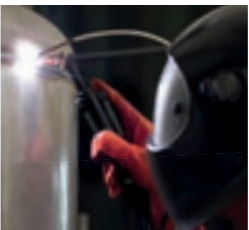
L’alimentatore filo freddo automatico Feed automatizza l’alimentazione filo.
