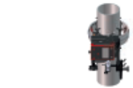
Saldatura su rotaie ad anello prefabbricate (tubi/serbatoi Ø 200 mm - 10 m)
