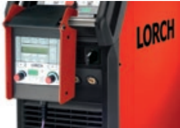
Pannello di comando estraibile per la gestione dell'alimentatore di filo freddo
