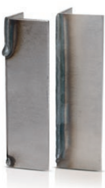
Una saldatura ad angolo a confronto. Arco standard (a sinistra): bagno di fusione rapidissimo, poco prima della discesa. SpeedCold (a destra): saldare in maniera completa, sicura e rapida (35 cm/min).
