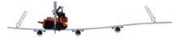
Saldatura su un piano concavo con rotaia di guida flessibile
