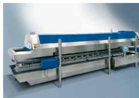
Tunnel di surgelazione Linea CRYOLINE®
