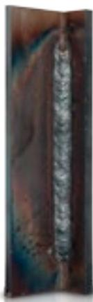
Non serve più nessun pendolamento, è sufficiente guidare l'elettrodo verso l'alto. La tecnologia MicorBoost, grazie alla tecnica di regolazione brevettata, fornisce sempre la potenza sufficiente a mantenere stabili l'arco e il bagno di fusione. Inoltre grazie al procedimento non si deve più saldare in due passate, basta una sola passata con l'elettrodo grande.
