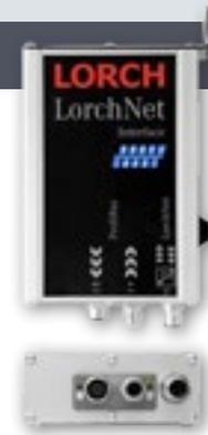
LED di stato per una semplice verifica della connessione.
