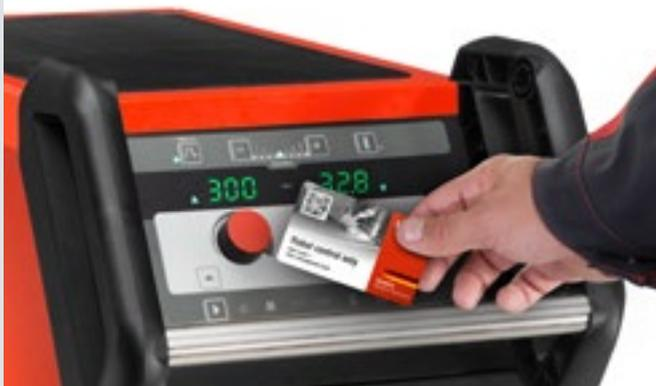
La tecnologia NFC con trasmissione dei dati senza contatto rende possibile l'identificazione e l'autorizzazione degli utenti in qualunque momento. La saldatrice è fornita di serie con due schede di autorizzazione: "Administrator" e "Robot control only".
